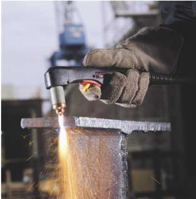
Figura 10 – Detalhe do Processo de Corte Manual
